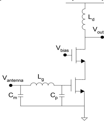
Fig. 2 LNA Schematic
